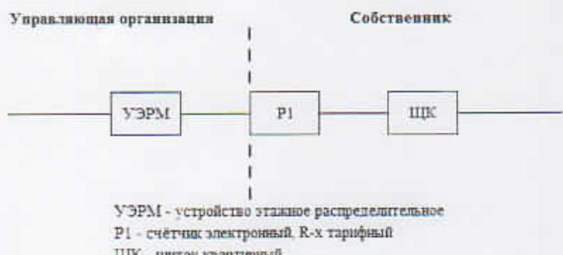
Исполнитель несет ответственность за надлежащее состояние и работоспособность питающих электрических сетей на квартиру согласно нижеследующей схеме до прибора учета (пунктирной линии слева).
