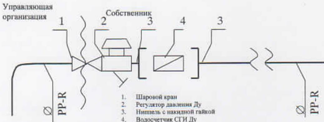
Исполнитель несет ответственность за надлежащее состояние и работоспособность систем горячего и холодного водоснабжения согласно нижеследующей схеме до волнистой линии слева (включая шаровой кран).
